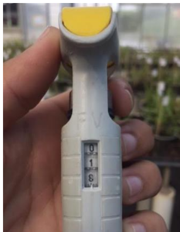
Figura 8. Micropipeta calibrada para aplicação de 18 \mu\text{mol.folha}^{-1} .
